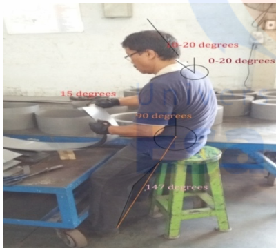
Gambar 4 Sudut Pergerakan Metode RULA untuk Elemen Kegiatan Mengambil Silicon Steel dari Meja Dorong
